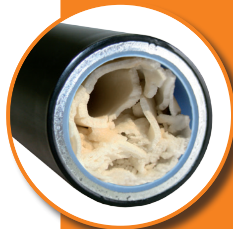
Kalkablagerungen an einer Kunststoff-Rohrleitung
