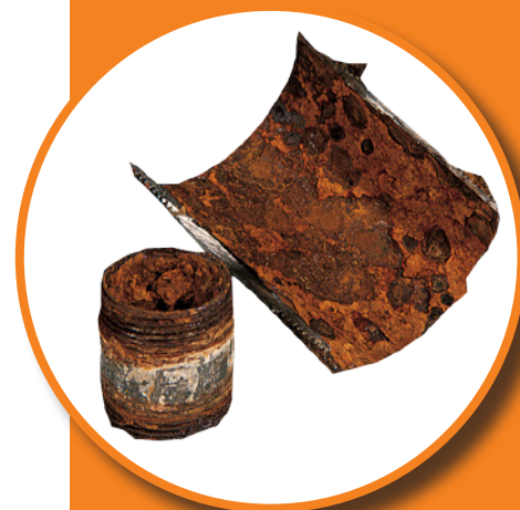
Korrosionen an Rohrleitungen
