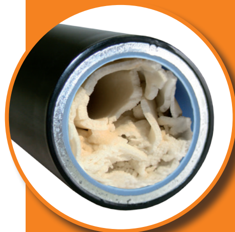
Kalkablagerungen an einer Kunststoff-Rohrleitung
