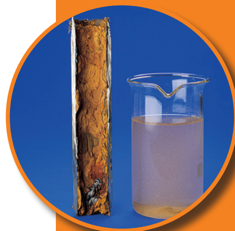
Korrosion an Rohrleitungen
