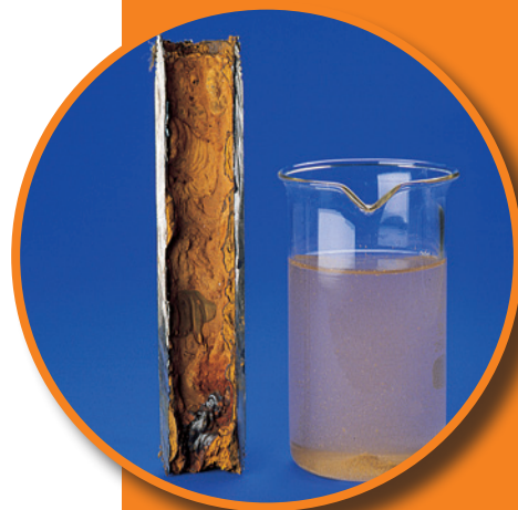
Korrosion an Rohrleitungen
