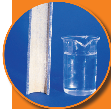
Rohrleitung mit Schutzschicht
