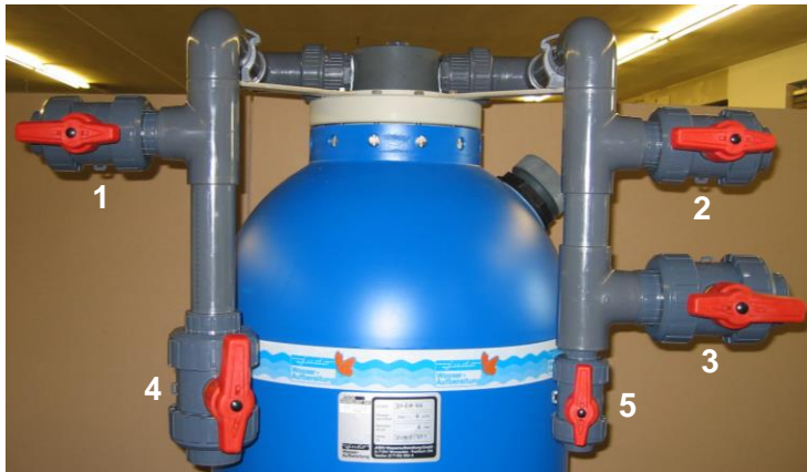
Abb. 4: Bedienung der Absperrarmaturen am E-Reihe-Filter
