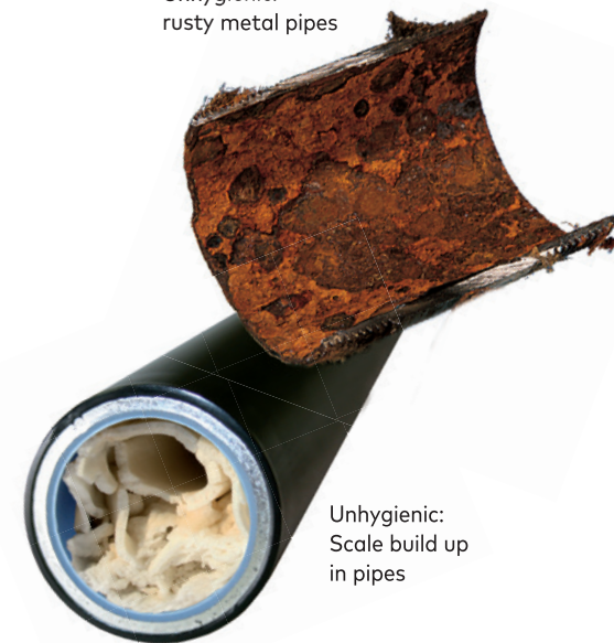
Unhygienic: rusty metal pipes
