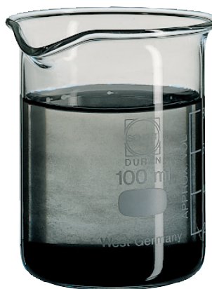
Magnetitschlamm im Heizungswasser – ein Anzeichen für Probleme
