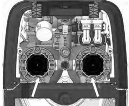
Abb. 12: Transportsicherungen nach oben abziehen
