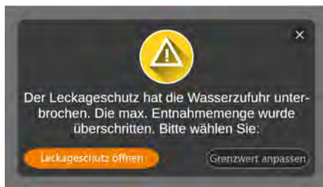
Abb. 15: Display-Anzeige bei automatisch geschlossenem Leckageschutz
