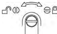
Abb. 20: Schlitz waagrecht: verriegelt. Der Salzbehälter ist gesichert.
