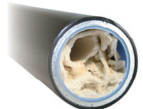
Kalkablagerungen an einer Kunststoff-Rohrleitung
