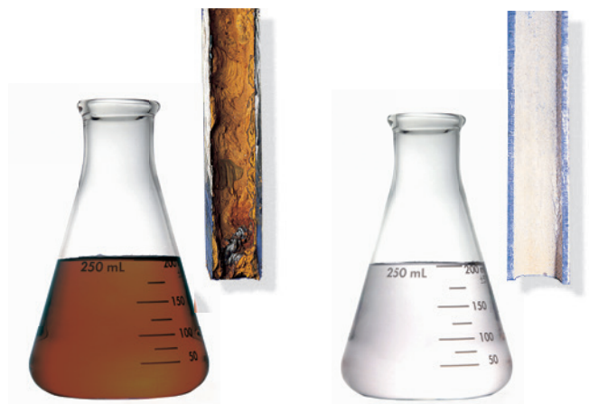
Korrodierte Rohrleitungen, trübes Wasser – ein Hygiene-Risiko
